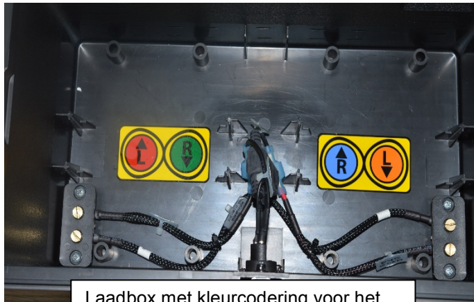
Laadbox met kleurcodering voor het extern opladen van 2 accu's.
